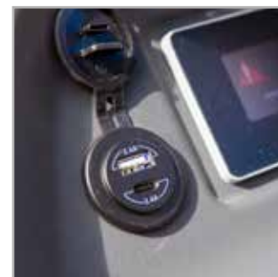
PUERTO DEL CARGADOR USB El tablero alberga un puerto de cargador USB-A y USB-C, cada uno de los cuales ofrece un máximo de 2,4 A.
