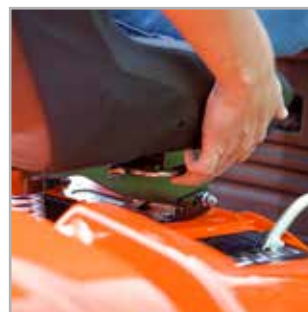
ASIENTO AJUSTABLE El asiento premium con respaldo alto se puede ajustar fácilmente con una palanca para brindar mucho espacio para las piernas.
